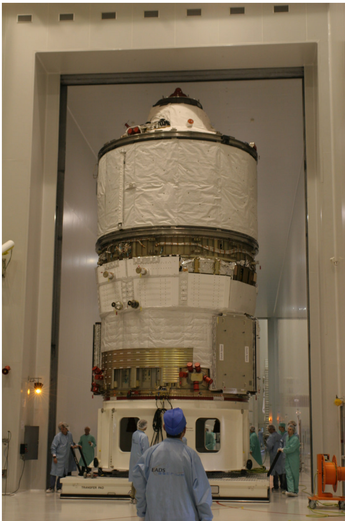
Le premier modèle de vol de l'ATV, le « Jules Verne » est transféré vers la zone de remplissage en ergols dans l'EPCU S5 (Ensemble de préparation des charges utiles) au Centre spatial guyanais.
