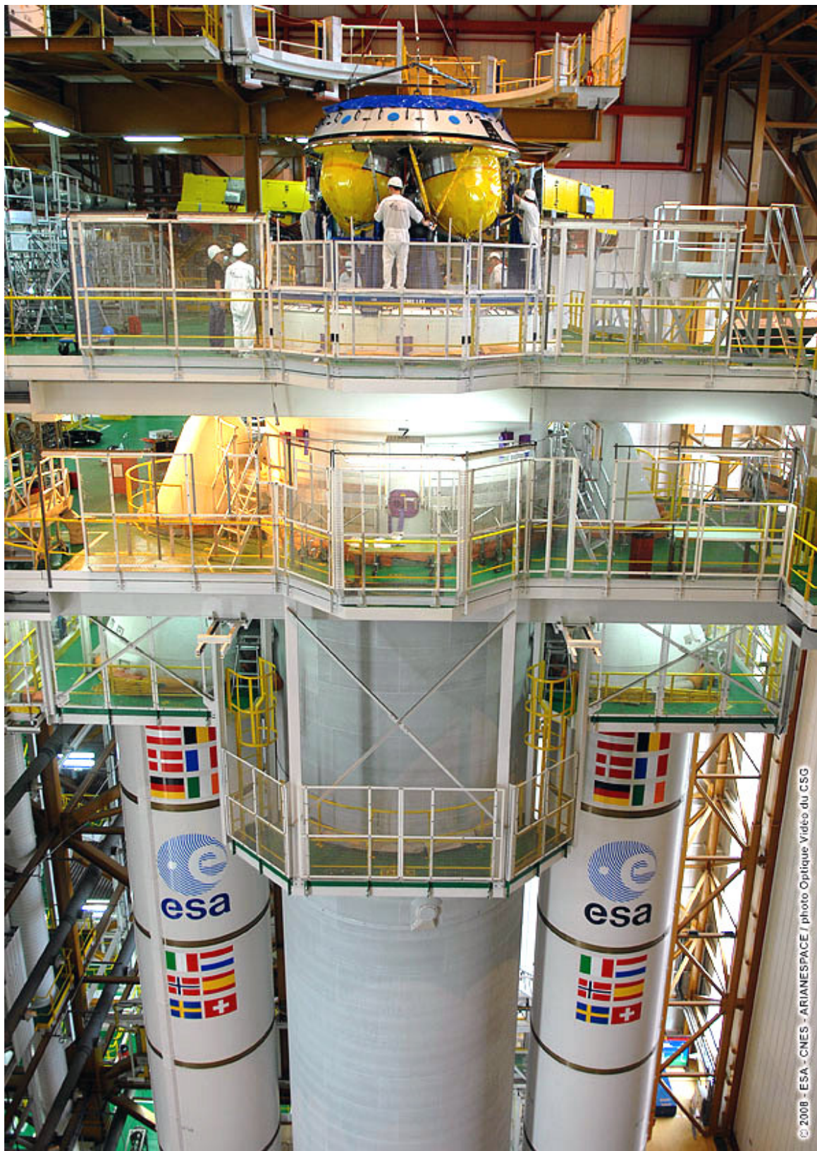
L'étage supérieur EPS est monté au sommet de la toute première Ariane 5ES, qui placera le « Jules Verne » sur orbite.
