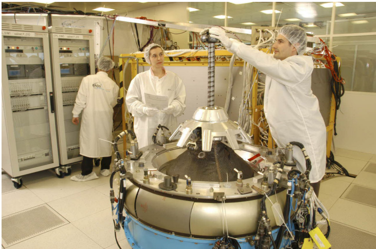
Un technicien travaille sur la sonde déployée d'un système d'arrimage russe réel intégré au banc d'essai de simulation fonctionnelle de l'ATV sur le site d'Astrium aux Mureaux.
