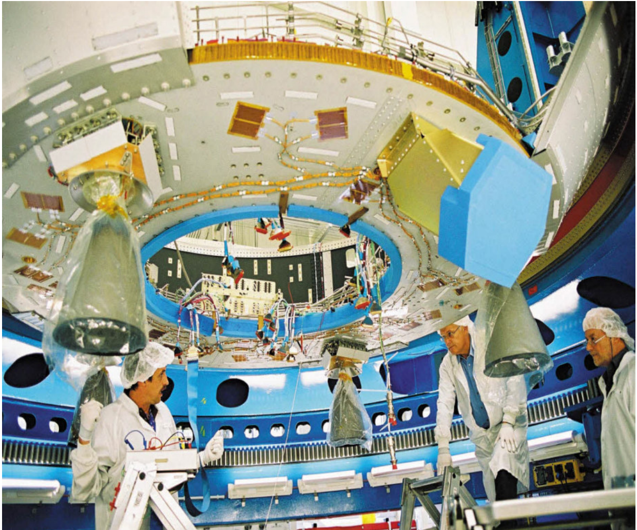
Intégration de la baie de propulsion de l'ATV sur le site d'Astrium à Brême. Les quatre moteurs principaux de 490 N de poussée sont clairement visibles.
